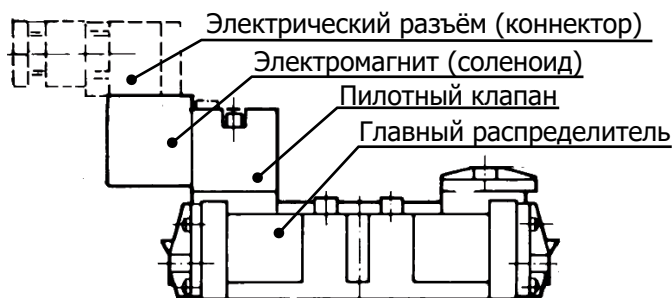
Рис. 7.37 - Распределитель серии 9 с электропневматическим управлением компании Samozzi
