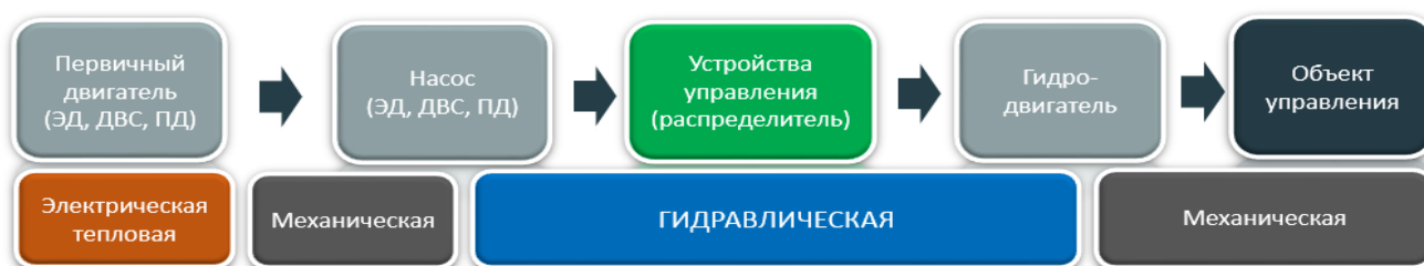
Рис.1 – Структурная схема гидро- и пневмопривода
